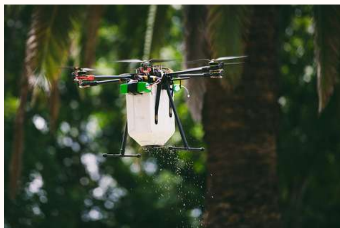
Drone realizando dispersão de sementes encapsuladas
