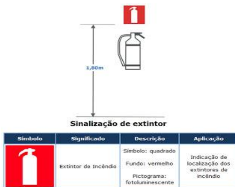
Figura 19 - Sinalização padrão do extintor de incêndio.
